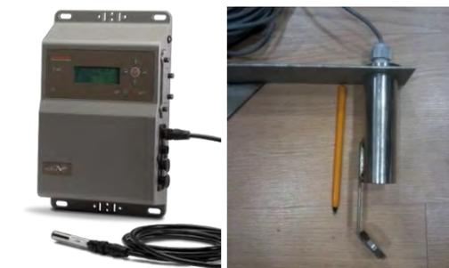
Figure 24 : SM3BAT (Wildlife Acoustics, USA) et protection du microphone utilisée lors de l'étude (Biotope)
