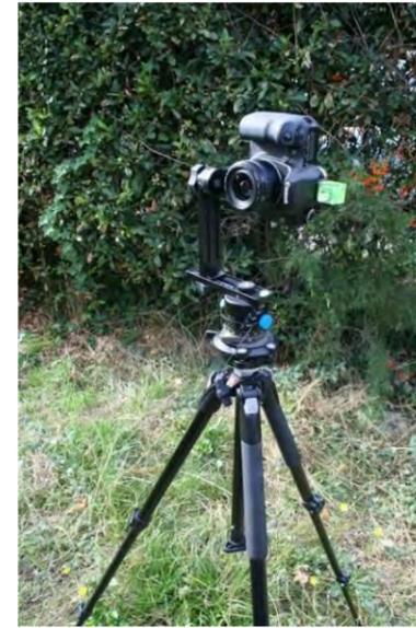
Les photos qui composent le panoramique sont prises avec un pied muni d'une rotule panoramique permettant d'éviter les distorsions et les mauvais raccords entre photos. Un niveau à bulle permet de vérifier la planéité de la photo (et d'éviter les mauvais raccords).
