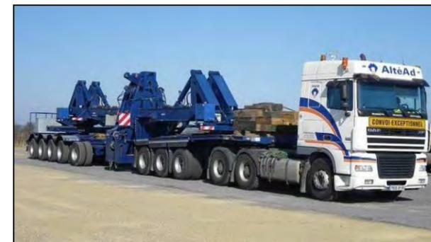
Photo 6 : exemple de camion assurant le transport des composants d'un parc éolien
